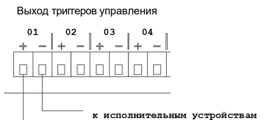
Рис. 3.5. Схема подключения внешних исполнительных устройств к LPA-PRESTA-2.
